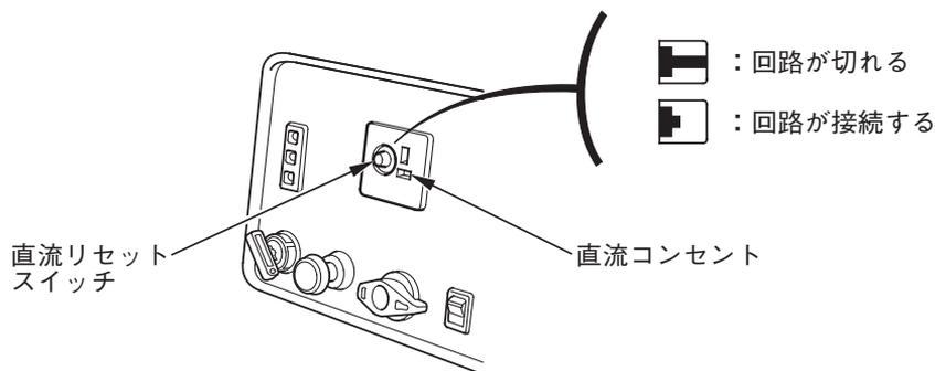
直流コンセントは直流電気を取出すところで、12Vバッテリーの充電専用です。交流電気を使用しているも直流電気を取出すことができます。
